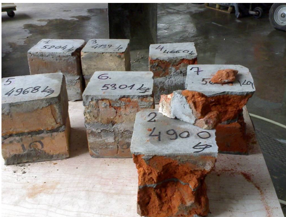
Rys 22. Próbkę cegieł po badaniu
