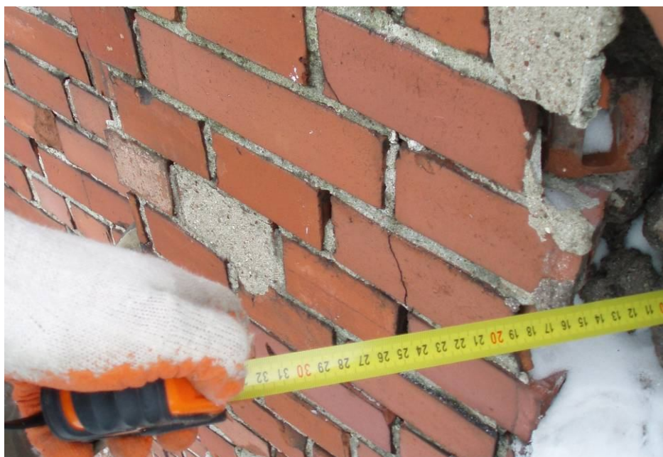
Rys.30. Pomiar głębokości uszkodzeń muru
