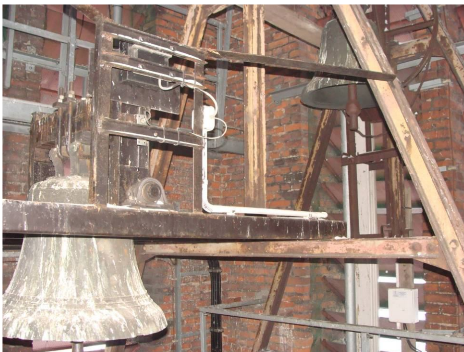
Rys. 15. Podwieszenie i napęd czynnego dzwonu
